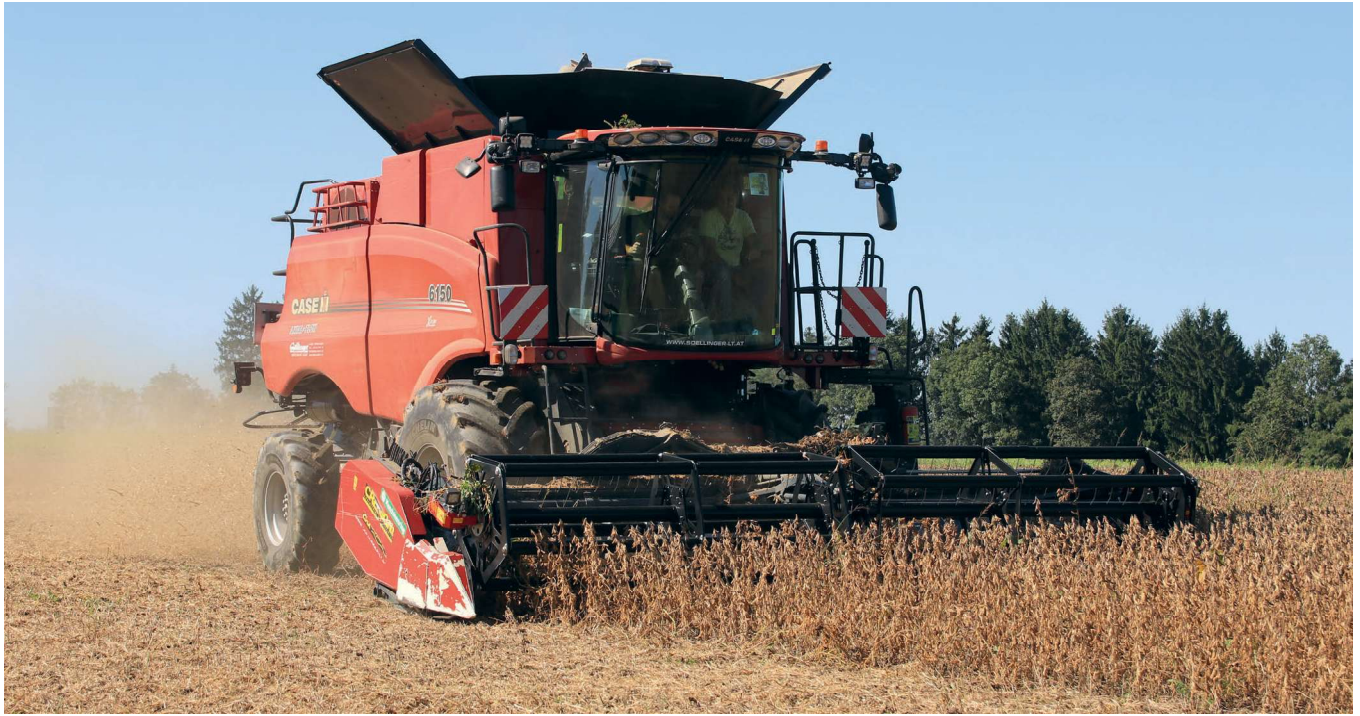
Das Cressoni CRX Sojaflex ist dank des flexiblen Messerbalkens für die Sojaernte geeignet.
