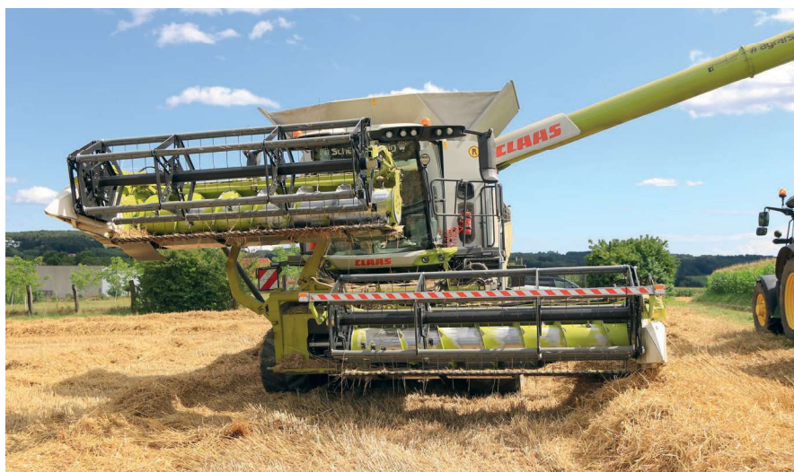
Beim Klappen für den Straßentransport muss der Fahrer nicht absteigen.
